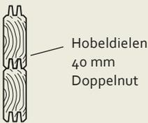
Die Hobeldielen (40 mm) sind mit einer Doppelnut versehen. Der Aufbau erfolgt durch gefälzte Holzstützen (wahlweise auch verzinkte Stahlträger), bei denen die Bohlen auf der Baustelle in den Falz eingeschoben und befestigt werden. Sämtliche Holzteile sind chromfrei kesseldruckimprägniert.
